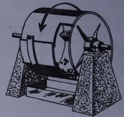
Fig. 19.4. Los Angeles Abrasion Test Apparatus.
