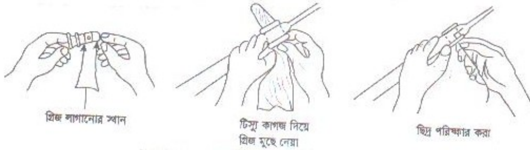
চিত্র ১.১৫ : ব্যুরেটের স্টপককে গ্রীজ লাগানোর প্রক্রিয়া।
