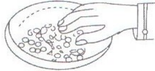
চিত্র ২.২৯ : ফিল্টার পেপার চেপে কেলাস শুষ্ককরণ,
