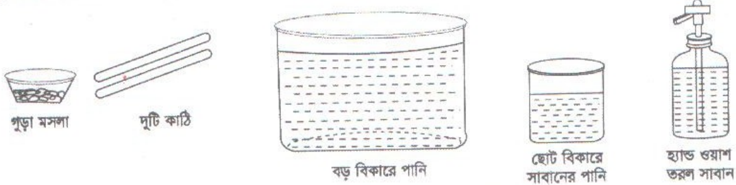
চিত্র ৩.৩৫ : পানিতে ডাইপোলার উপস্থিতি প্রমাণের পরীক্ষা।
