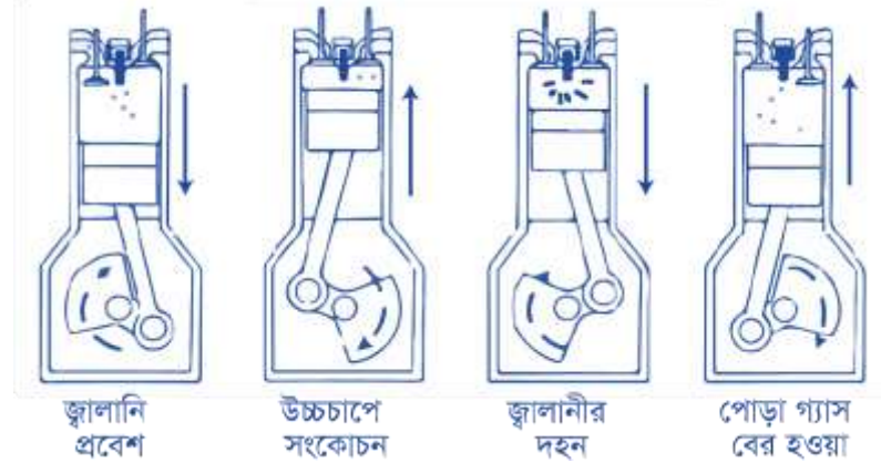
চিত্র: চতুর্ঘাত পেট্রোল ইঞ্জিনের কার্যপ্রণালি
